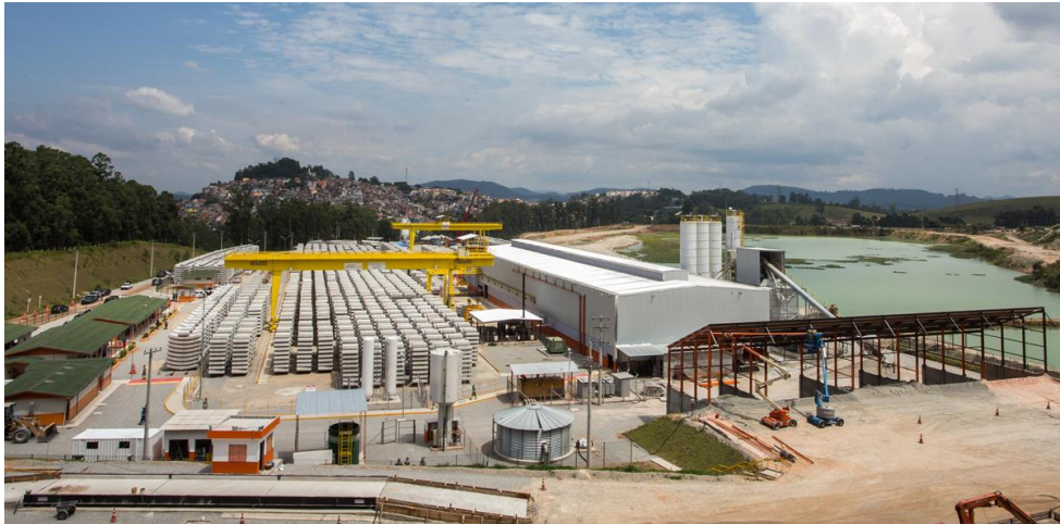
Figura 53 - Fábrica das aduelas para túneis da Linha 6-Laranja
