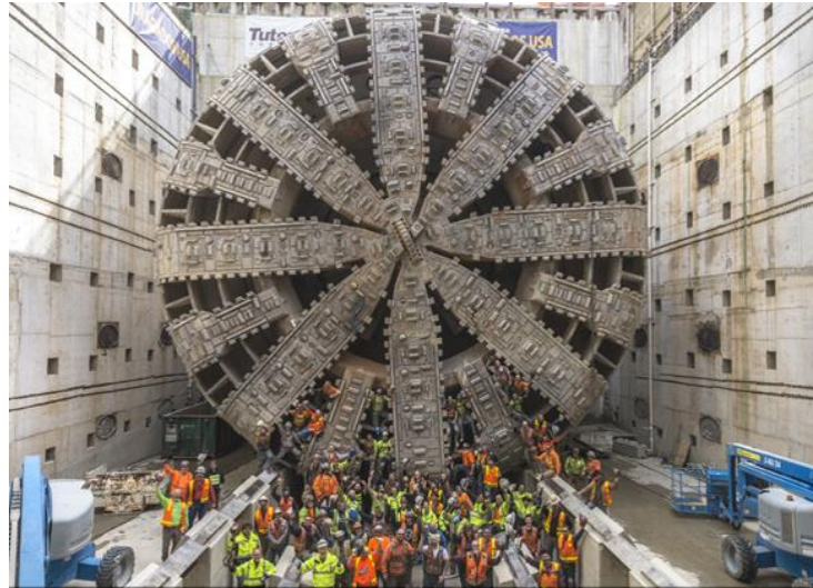
Figura 59 - TBM Bertha no final da escavação do túnel
